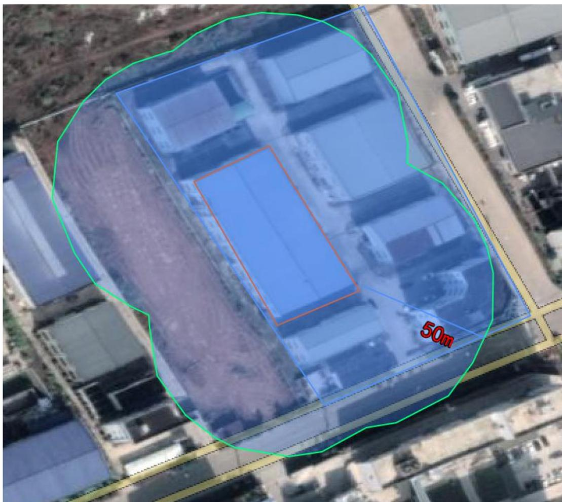
图 9-1 卫生防护距离包络线图
