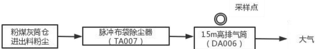
图 3-8 粉煤灰筒仓进出料尘处理的工艺流程图及验收监测采样点示意图
