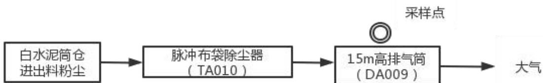
图 3-11 白水泥筒仓进出料尘处理的工艺流程图及验收监测采样点示意图
