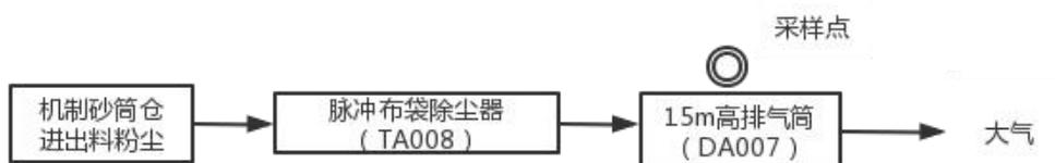
图 3-9 机制砂筒仓进出料尘处理的工艺流程图及验收监测采样点示意图
