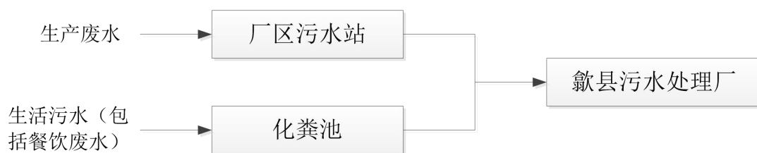
图 4.2-1 厂区污水收集及处理流程示意图
