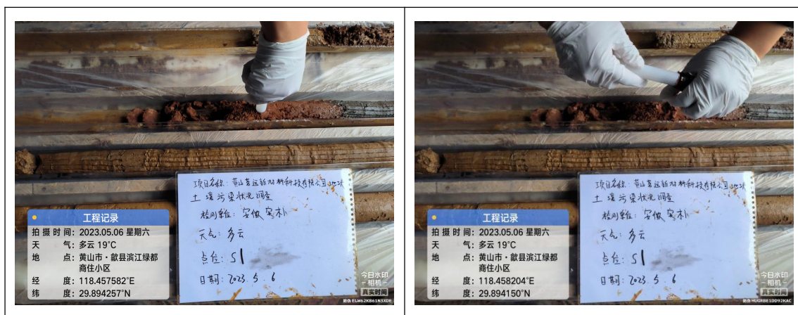
图 4.3-5 土壤 VOCs 样品采集照
