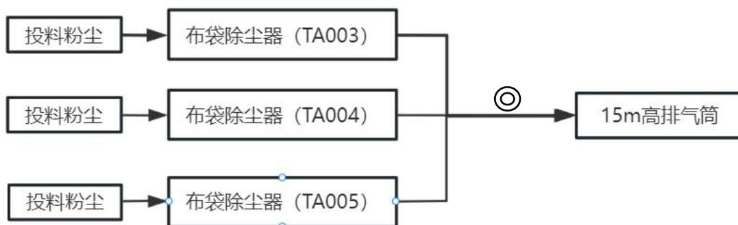
图 3-2 投料粉尘监测点位示意图
