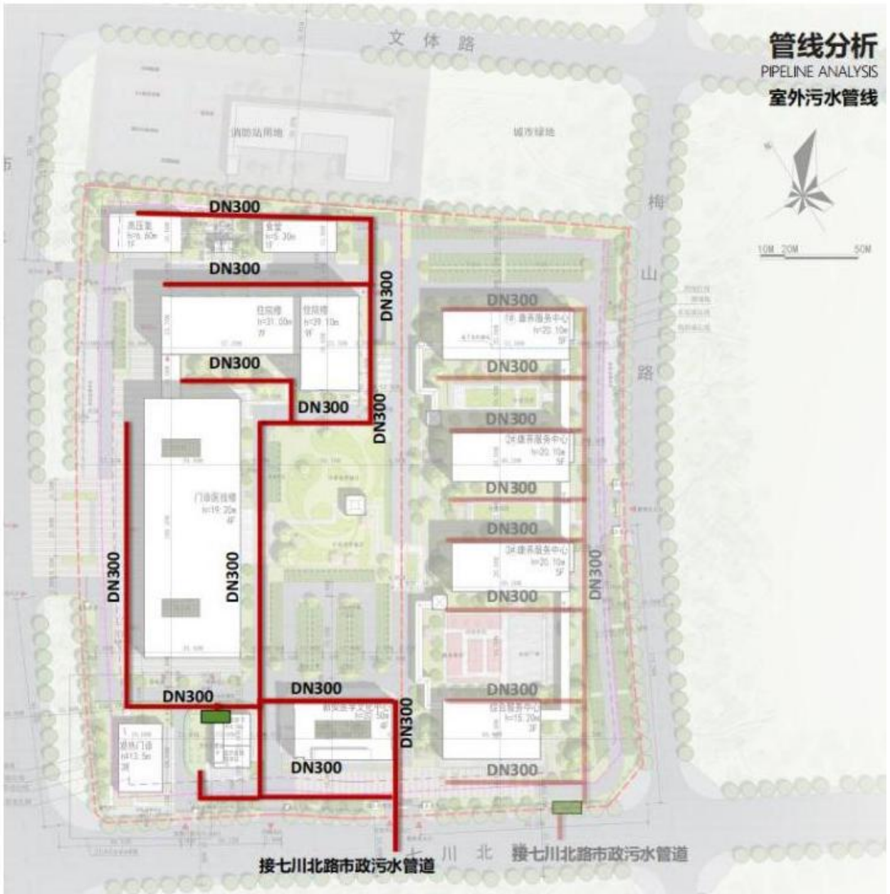
附图 4 污水管线布置图
